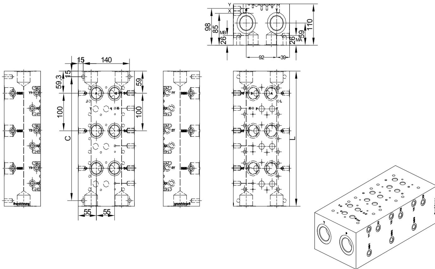
**Beispielplan: XY Anschlüsse Einzel angesteuert**
